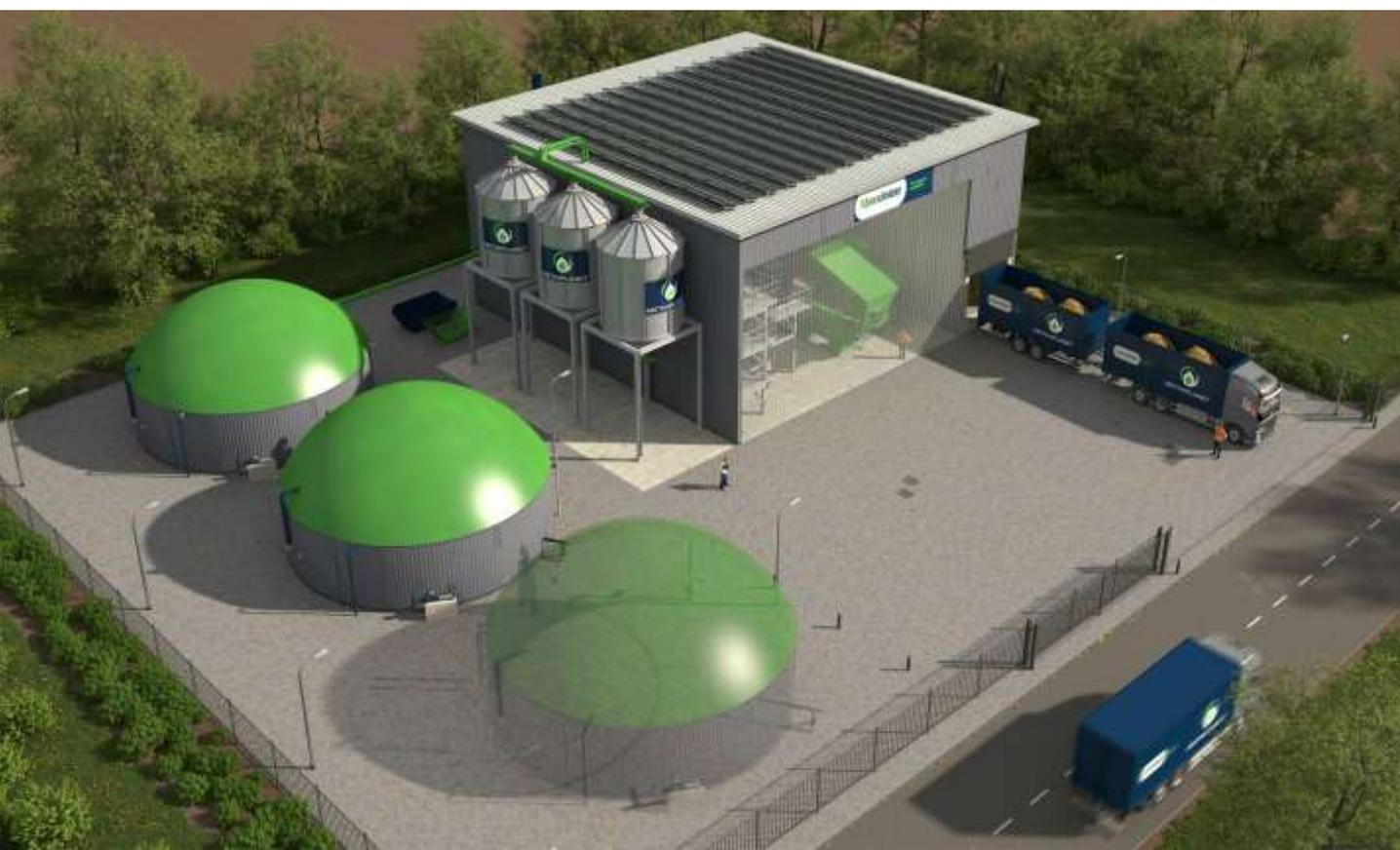
**Sistema de digestão anaeróbica para quantidades de substrato a partir de 4.500 t/a**
